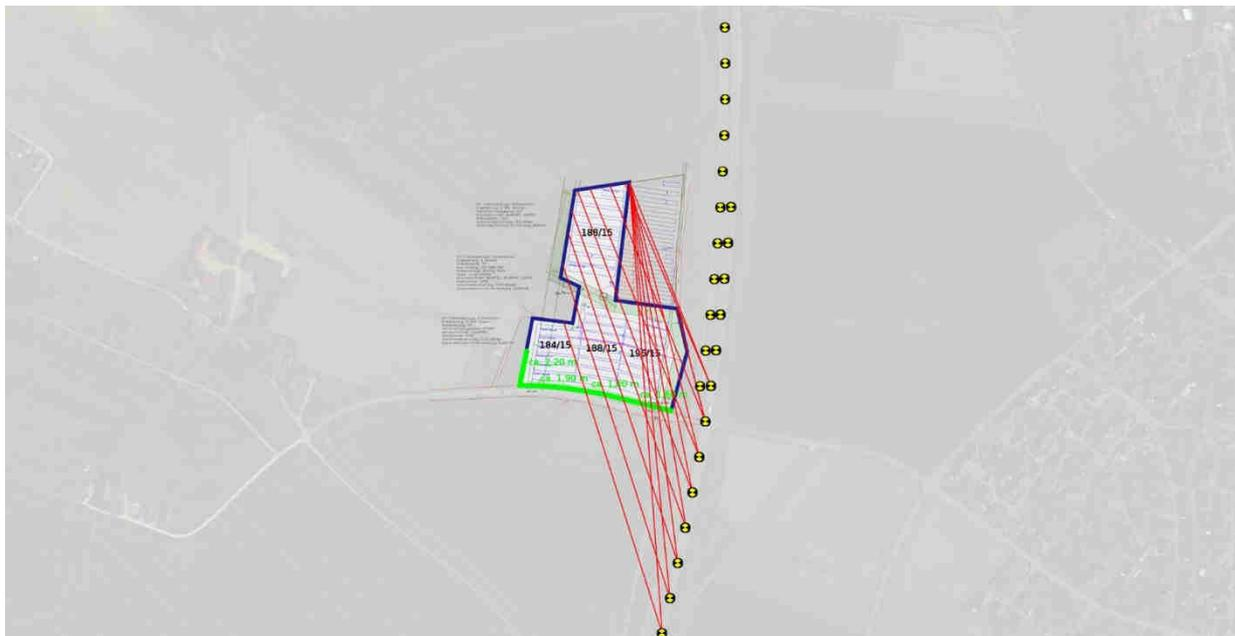
Reflexionen mit höheren Leuchtdichten, die ggf. als Blendung empfunden werden können, treten in dieser Fahrtrichtung erst bei Blickrichtungen auf, die mehr als ca. 70° von der Hauptblickrichtung der Fahrer abweichen. Diese hohen Reflexleuchtdichten werden zwar im peripheren Sichtfeld wahrgenommen, sie sind für die Sicherheit des Verkehrs auf der Autobahn jedoch von untergeordneter Bedeutung.
